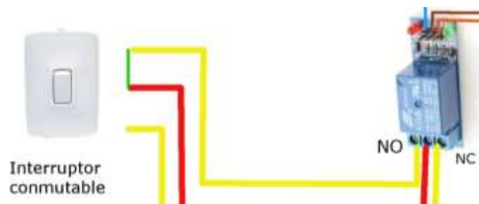
Figura 18: conexión de relay hacia interruptor de doble vía
