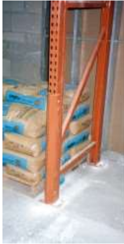
Los tirantes del estante están reforzados contra cualquier daño del montacargas
