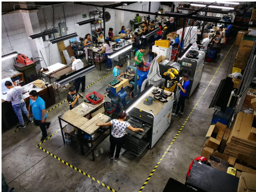
Ilustración 59 Señalización de áreas de trabajo realizadas
