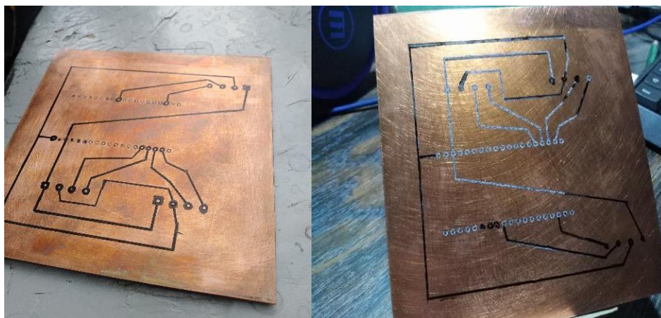
Figura 22 Diseño electrónico grabado sobre pista de cobre virgen (Fuente propia).
