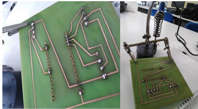
Figura 26 Elementos soldados sobre la pista (Fuente propia)
