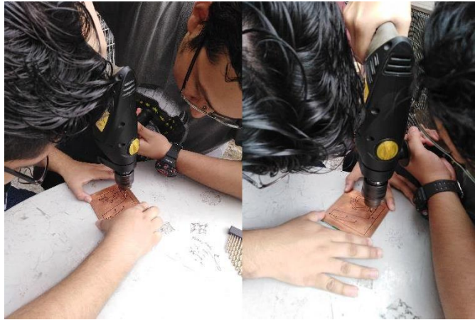
Figura 23 Perforación de Pista de cobre (Fuente propia).
