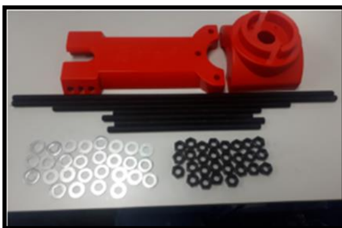
Figura 4 Partes que componen la estructura
