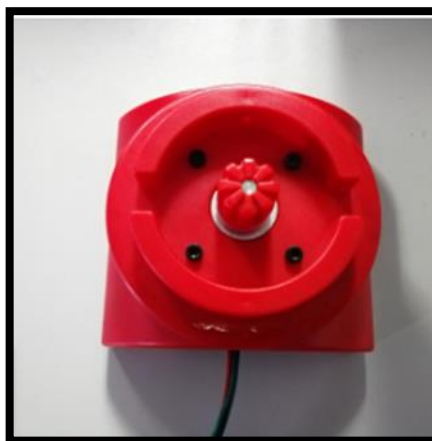
Figura 3 Colocación de moto paso a paso
