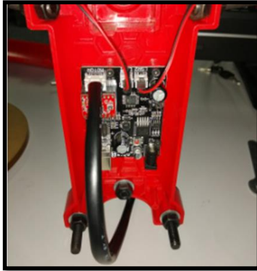
Figura 11 Se conectan los dos láseres en la placa
