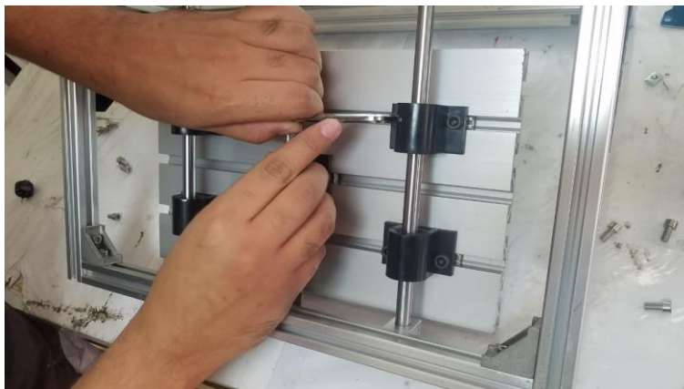
Figura 3 Colocación de bloques deslizantes
