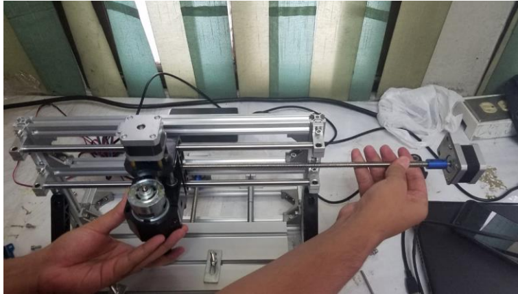
Figura 9 Colocación de riel tipo esparrago y motor perfiles en vertical de la maquina
