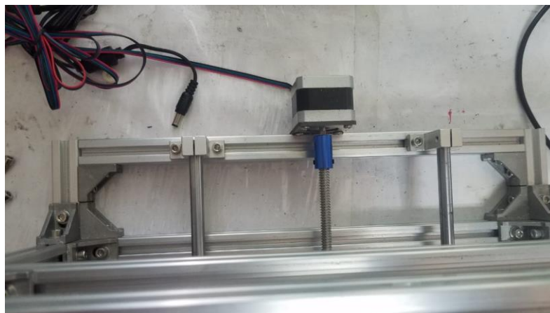
Figura 5 Instalación de motor eje x
