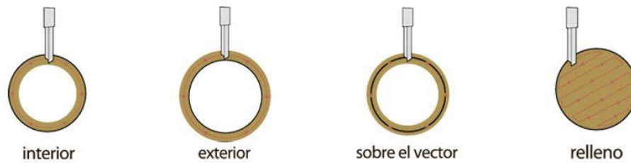
Ilustración 3: Tipos de corte que realiza la broca de una CNC en tallado de materiales.
