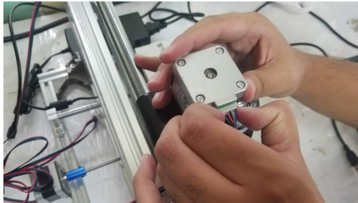
Figura 11 Instalación de cableado en motores nema 17
