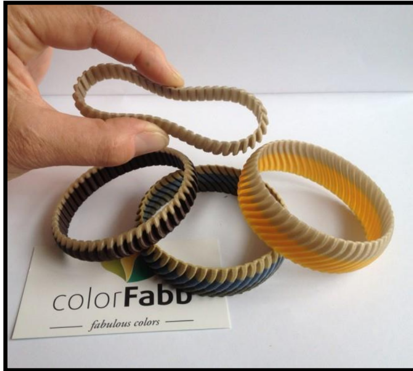
Figura 9: Piezas fabricadas con Soft PLA.
