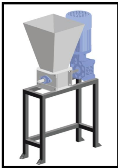
Figura 14: Prototipo de trituración para plástico.
