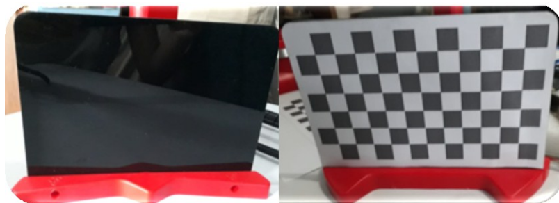
Figura 24, uniendo soporte del patrón con la superficie acrílico
