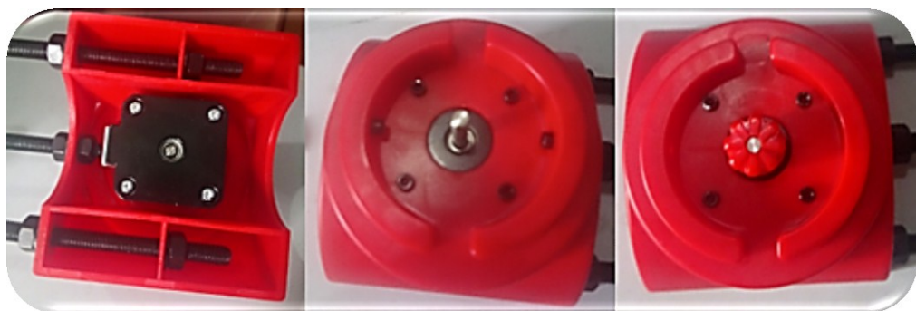
Figura 16 colocación de la estructura del motor
