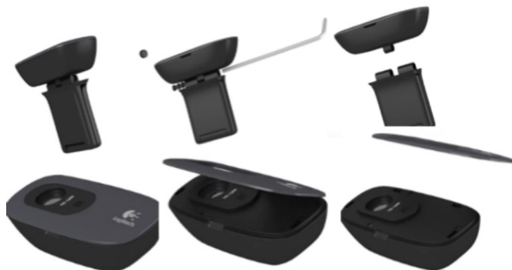
Figura 18 Desarmado de la cámara
