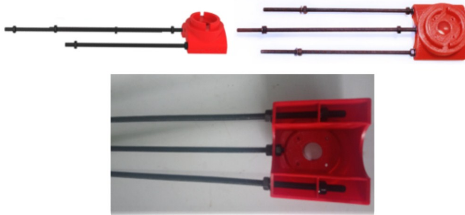
Figura 10 Base del motor
