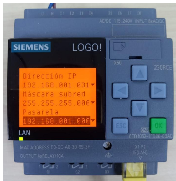
Figura 28: Configuración de LOGO! PLC
