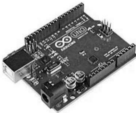
Figura 7: Es una placa electrónica basada del microcontrolador ATmega328
