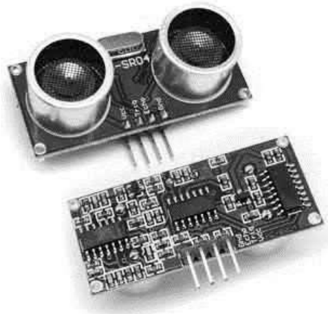
Figura 11: El sensor de ultrasonidos HC-SR04
