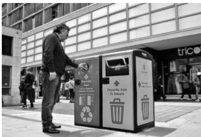
Figura 2: El basurero inteligente le avisara al encargado de la recolección de la basura cuando esté lleno mediante un led rojo.
