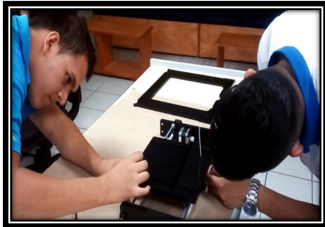
Imagen 14.colocacion de cintas de nylon a los rodamientos
