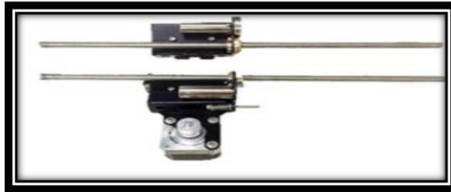
Imagen 30. varillas lisas montadas en los soportes
