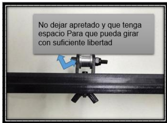
Imagen 9.colocando soporte de correa en la placas de acrílico
