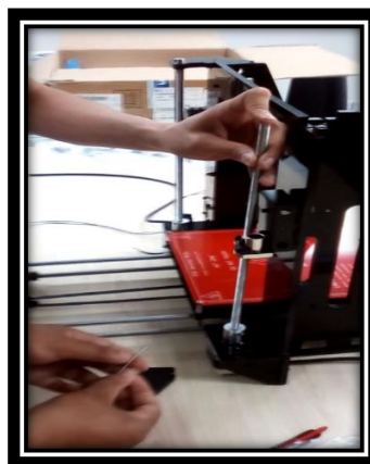
Imagen 31. montaje de varillas lisas y roscadas
