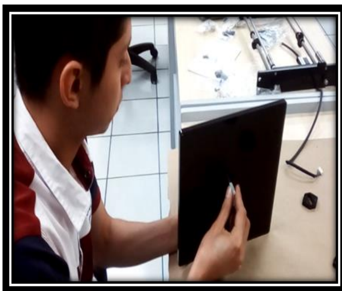
Imagen 12.montaje soporte de correa en el soporte de cama caliente
