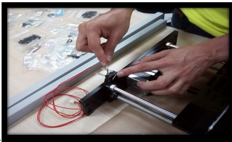
Imagen 17.ensamblaje del final de carrera
