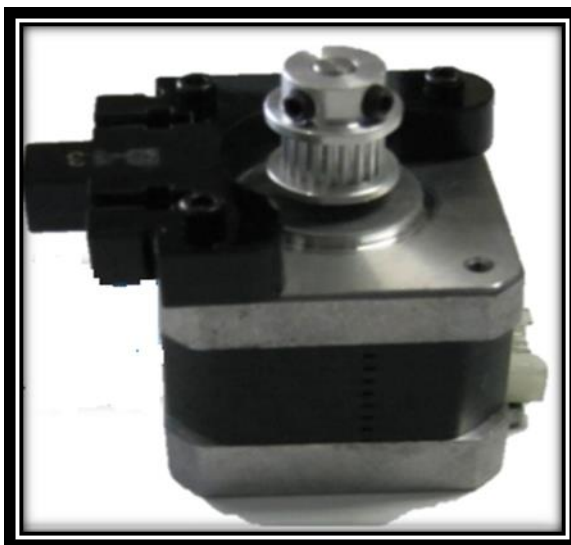
Imagen 10.colocando el soporte en el motor
