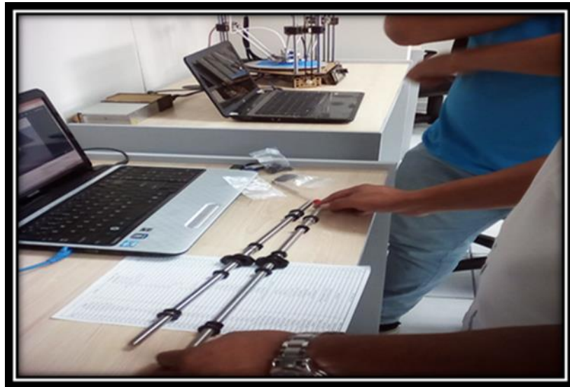
Imagen 2. montaje de las varillas para el eje Y.
