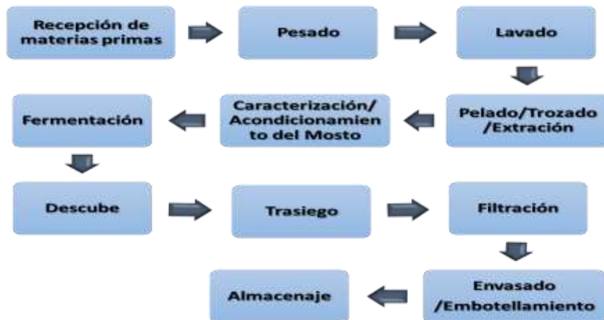
Figura 1. Esquema tecnológico de la fabricación de vinos de frutas
