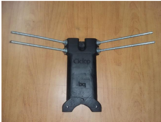
Figura 4, varillas roscadas de 15cm.
