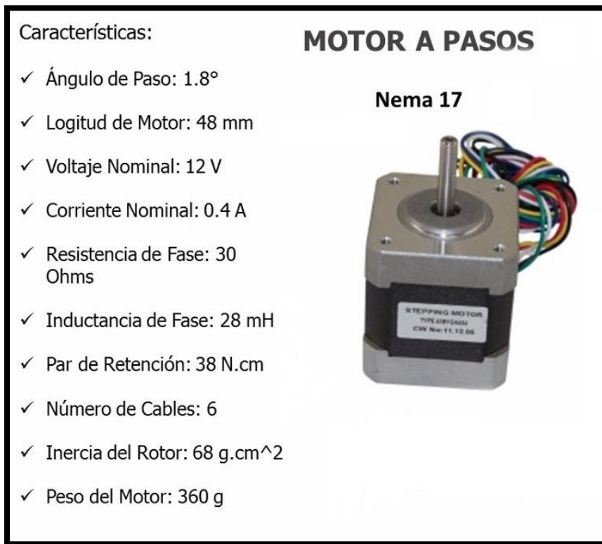
Imagen 8, características de voltaje y corriente del motor paso a paso
