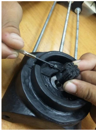
Figura 14, colocación del acoplamiento del eje con el motor nema 17.
