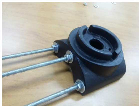
Figura 9, colocación de las varillas roscadas de 30cm y 40cm en la pieza de soporte del motor.
