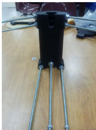
Figura 7, colocación de las varillas roscadas de 30cm y 40cm.
