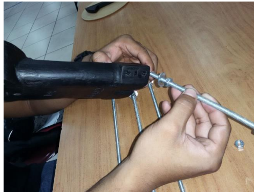
Figura 2, varillas roscadas de 15cm
