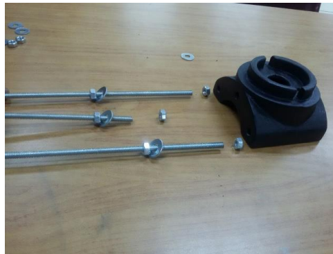
Figura 8, colocación de las varillas roscadas de 30cm y 40cm en la pieza de soporte del motor.
