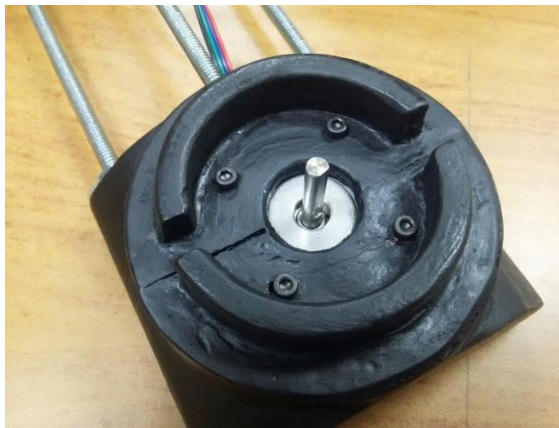
Figura 12, ya colocados los tornillos en el soporte del motor pasó a paso nema 17.
