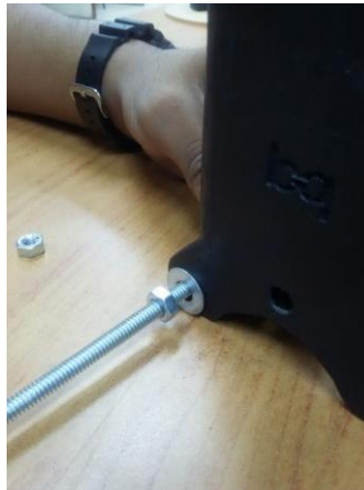
Figura 6, varillas roscadas de 40cm.
