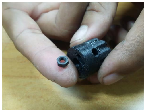
Figura 13, colocación de la tuerca en el acoplamiento del eje.
