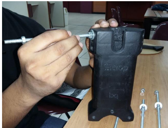
Figura 3, varillas roscadas de 15cm
