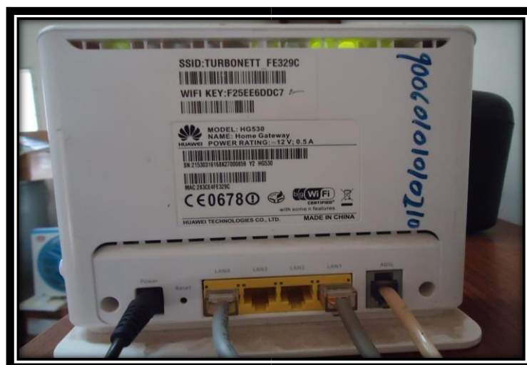
Figura 2.1.6.1 Imagen demostrativa modelo de Modem ADSL que brinda servicio de internet.
