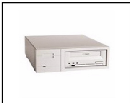
Figura 28. Unidad de Tape Backup
