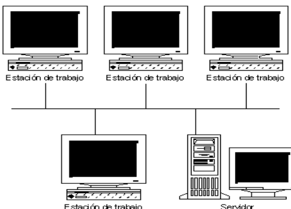
Figura N° 6 Esquema de una red con Topología en Bus
