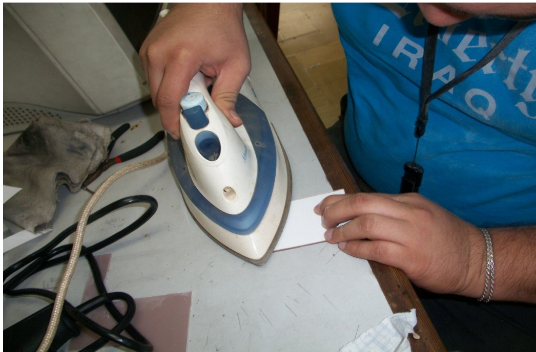
Figura 4.3 Planchado de circuito electrónico
