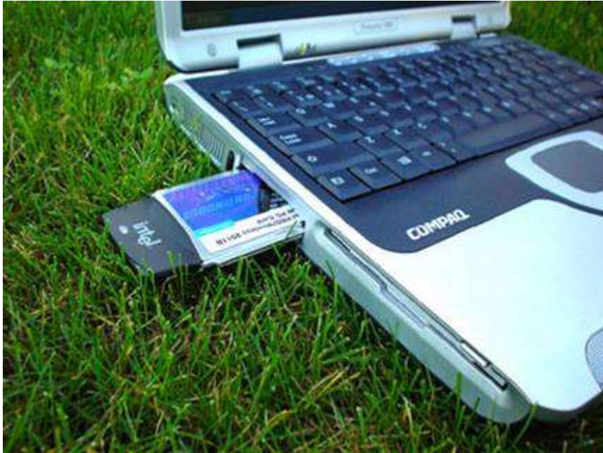
Imagen 5: Instalación de la tarjeta PCMCIA para el portátil.
