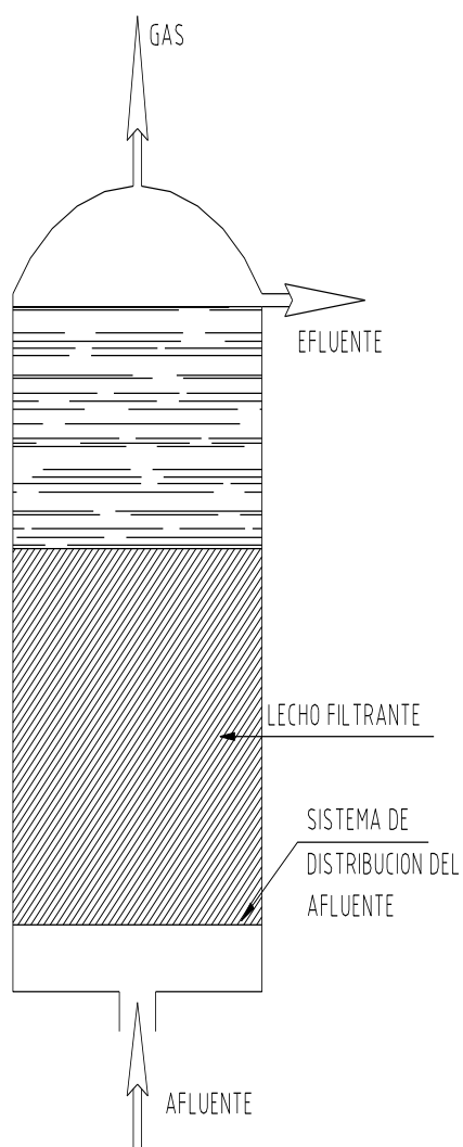
ESQUEMATIZACION DEL FILTRO ANAEROBICO CON FLUJO ASCENDENTE
