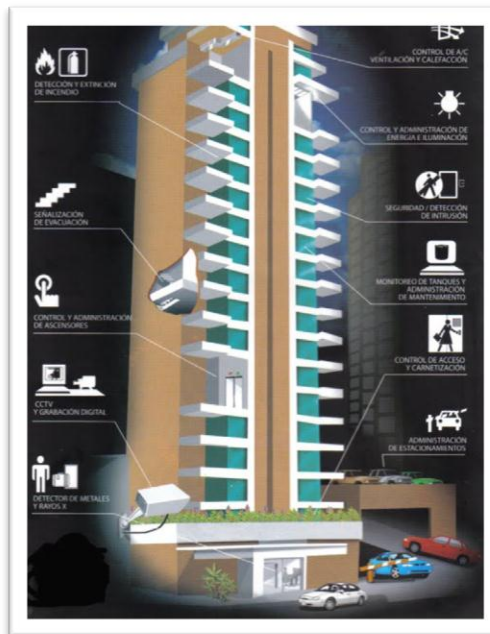
Figura 2.2 Gestión técnica de un edificio inteligente (Inmótica)
