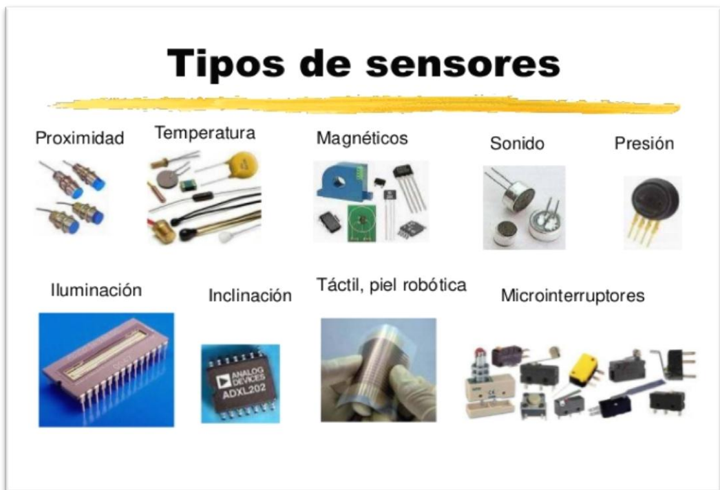
Figura 2.9 Algunos tipos de sensores. Fuente: http://es.slideshare.net
