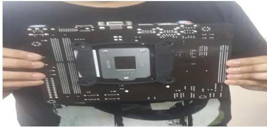
Imagen 6: Instalación de la placa de soporte.
