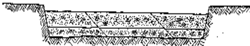
RELLENO DE TRINCHERA
