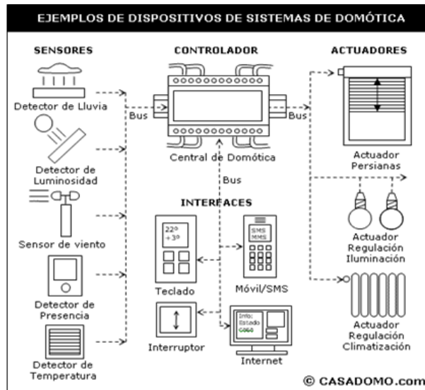
Figura 1, estructura de un sistema domótico, casadomo.com.
