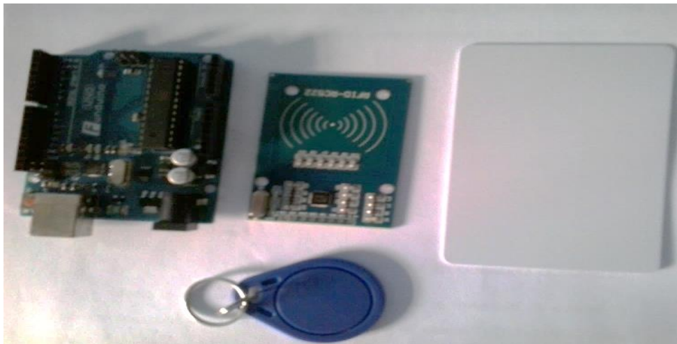
Figura 3.1 “partes del circuito sin ensamblar” fuente: propia
