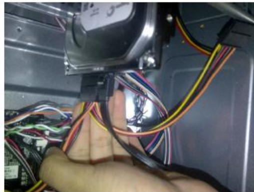
Figura N°10, conexión de disco duro, a Motherboard y fuente de alimentación.
