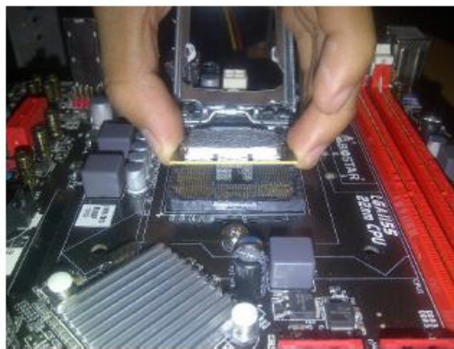
Figura N°5, Instalación de microprocesador
