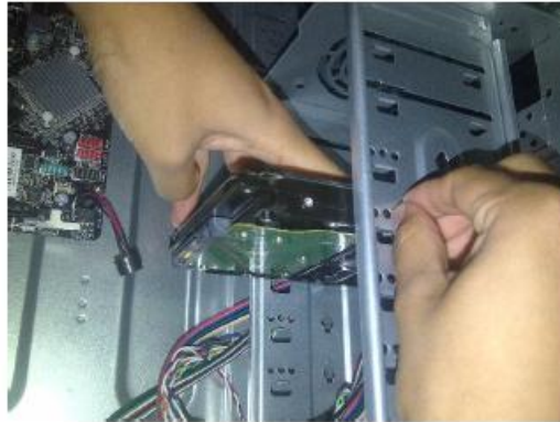
Figura N°9, instalación de disco duro
