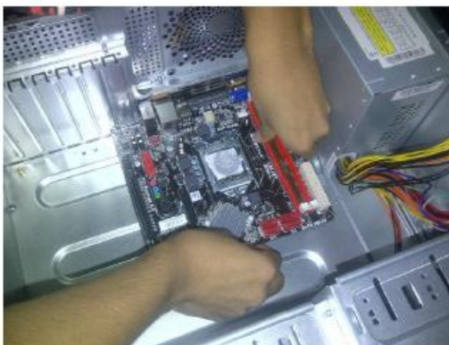
Figura N°4, instalación de Motherboard
