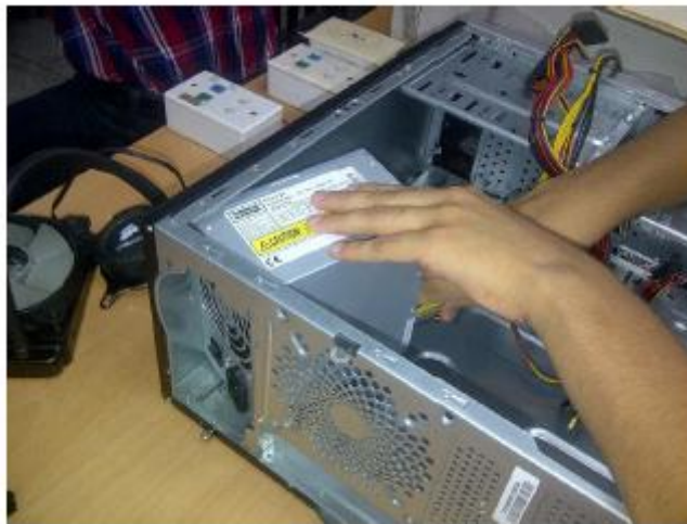
Figura N°3, Instalación de fuente de Voltaje
