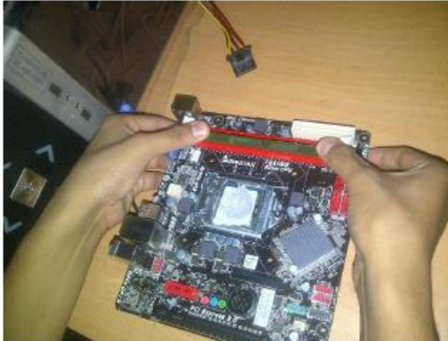
Figura N°6, instalación de Memoria RAM
