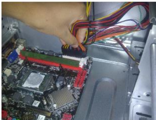
Figura N°7, conexión de fuente de voltaje a Motherboard
