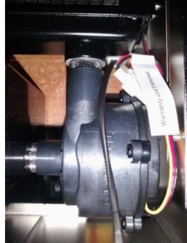
Bomba de líquido refrigerante
