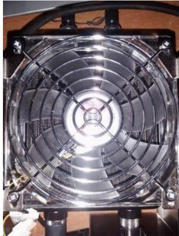
Ventilador del radiador.
