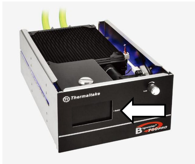
Figura 38 Medidor del tanque señalado.
