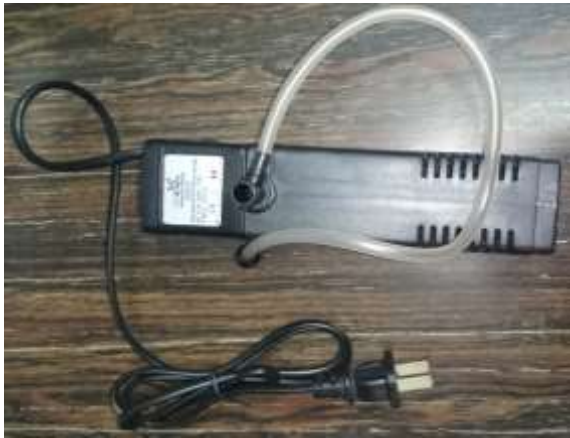
Figura 28 bomba de agua.
