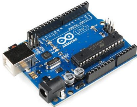
Figura 2.16 plataforma de desarrollo eléctrico Arduino Fuente: start.iminent.com
