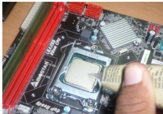
Fig. 13, Colocando la pasta térmica
