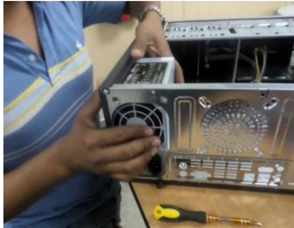
Fig. 9, Instalación de la Fuente de Poder
