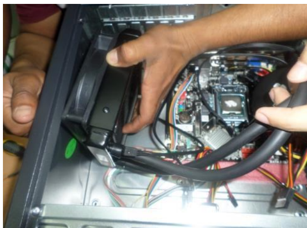
Fig. 23, Montaje del radiador
