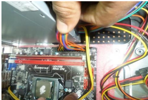
Fig. 21, Conexión de la fuente de poder a la motherboard
