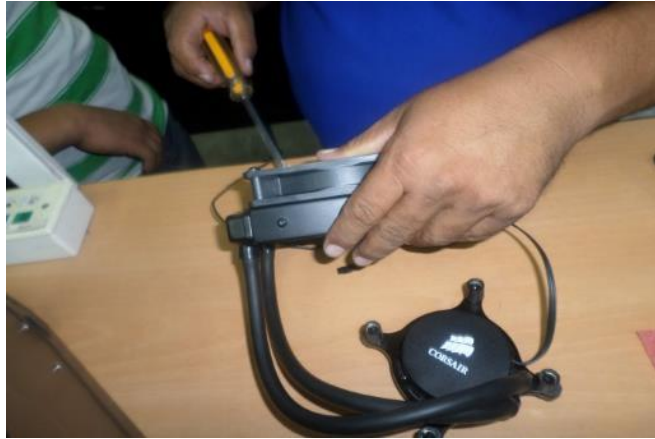
Fig. 15, Instalación del ventilador al radiador
