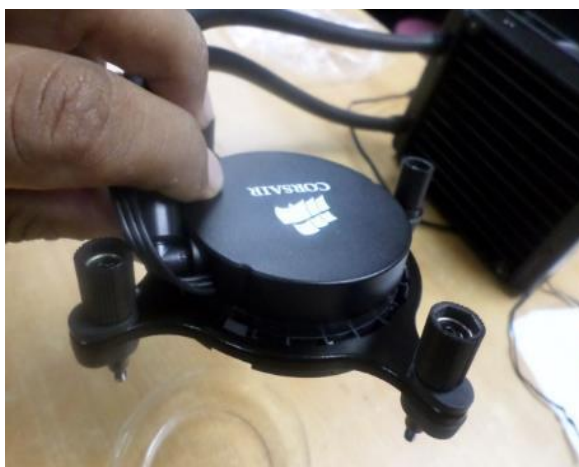
Fig. 18, Instalación del anillo de retención
