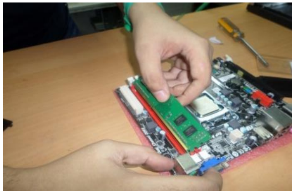
Fig.14, Montaje de la memoria RAM
