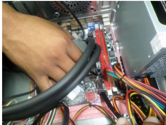
Fig.24, Montaje de la unidad de refrigeración al microprocesador
