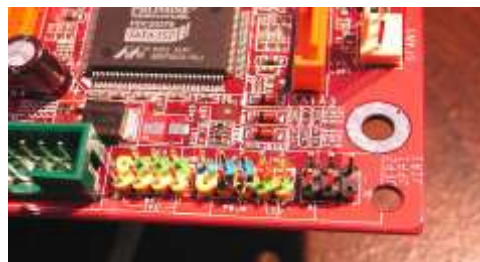
Fig. 2.46: Panel Frontal donde se conectan los interruptores
