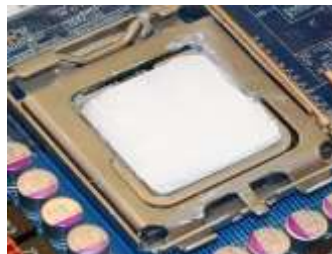
Fig. 2.37: Pasta térmica en toda la superficie del Microprocesador
