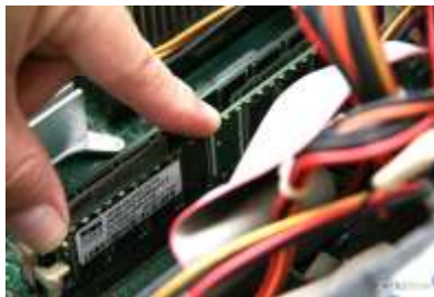
Fig. 2.42: Colocar RAM en bancos de memoria DIM
