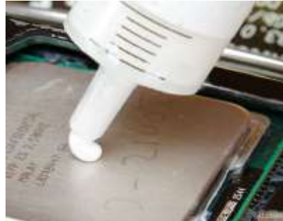
Fig. 2.35: Echar Pasta térmica al Microprocesador
