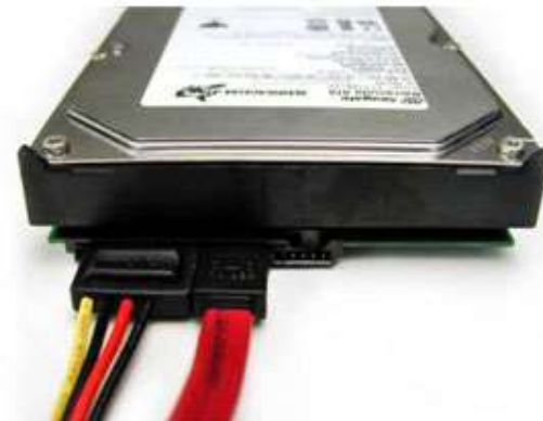
Fig. 2.48: Conectar la cincha al disco Duro.
