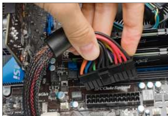
Fig. 2.44: Colocar el conector P1 (Power) en la motherboard
