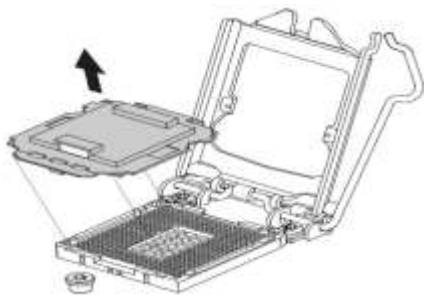
Fig. 2.28: Retirar mecanismo de Protección del socket
