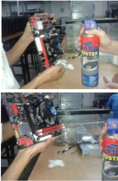
Fig. 2.62: Limpieza de Motherboard con aire comprimido. Fuente: Fuente propia.
