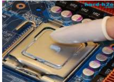
Fig. 2.36: Distribuir la Pasta térmica en el Microprocesador
