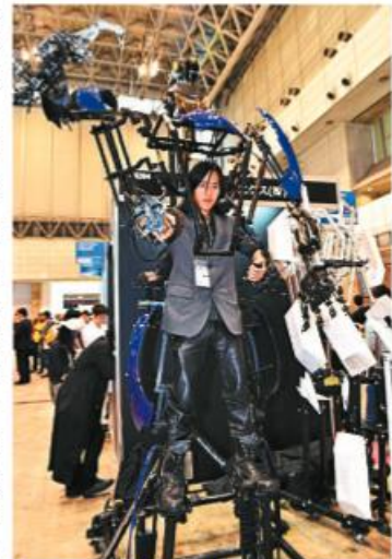
El exoesqueleto "Skeletronics" es un traje robótico liviano para ampliar el alcance de las extremidades. FOTO ECH / AGENCIA
