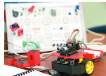
El entrenador consta de una consola en donde se han simulado varios escenarios, como semáforos y de un vehículo a escala.
