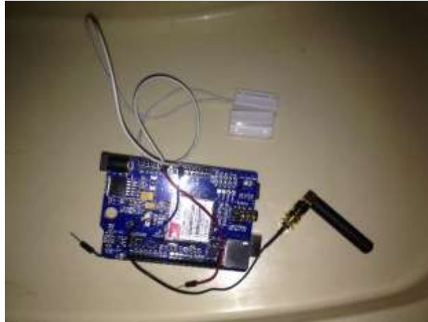
Figura 3.12. "Arduino conectado con sensor magnético"
