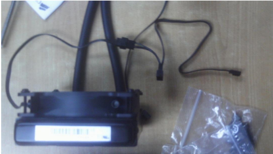
Figura N°14, instalación de extensiones a sistema de enfriamiento
