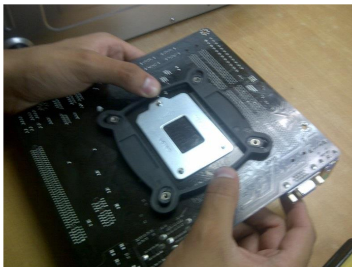
Figura N°15, colocación de base del sistema a Motherboard
