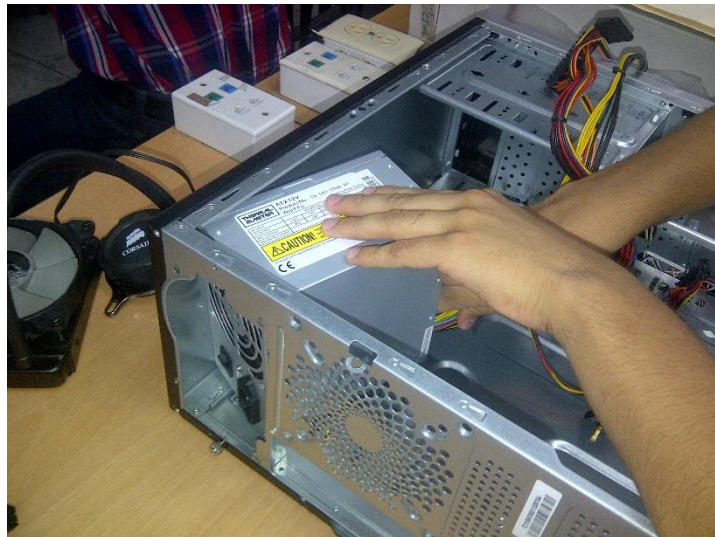
Figura N°4, Instalación de fuente de Voltaje
