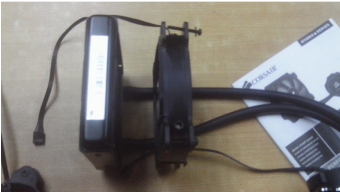
Figura N°13, colocación de cooler a radiador
