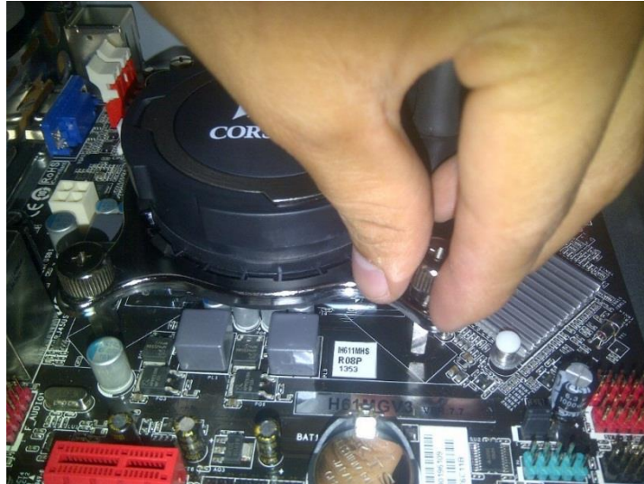
Figura N°19, fijación de bomba en Motherboard
