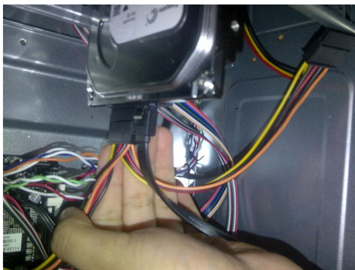
Figura N°11, conexión de disco duro, a Motherboard y fuente de alimentación.
