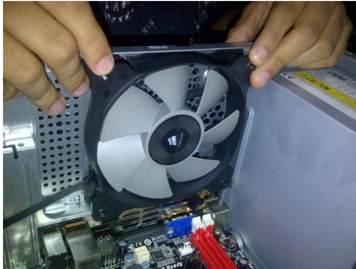
Figura N°17, colocación del segundo ventilador
