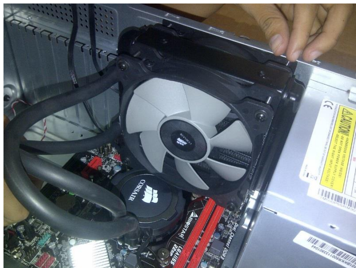
Figura N°20, fijación de radiador en case
