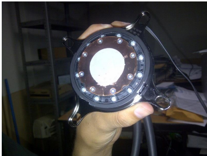
Figura N°18, colocación de pasta térmica en la base que ira en el microprocesador
