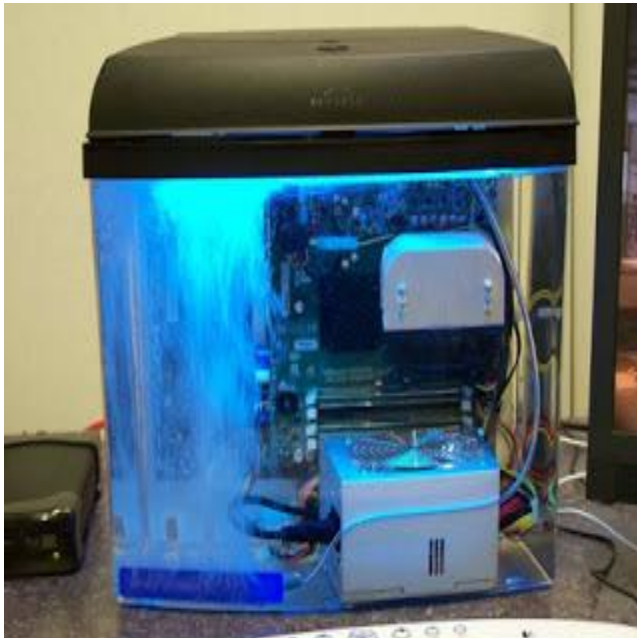
Imagen 2.5: Muestra la refrigeración en aceite mineral
