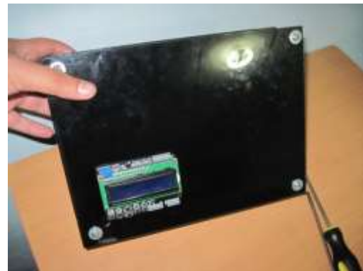
Figura 3.5 Se unieron las piezas del acrílico utilizando tornillos de 5 pulgadas
