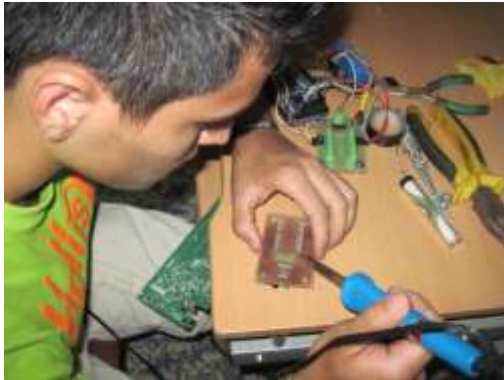
Soldadura de las borneras VCC/GND y pines hembra para módulo DS 1307 y vista trasera de la tableta de cobre finalizada después de la soldadura.
