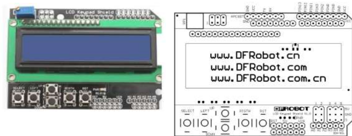
Figura 2.11 Esquema físico y electrónico de la pantalla LCD
