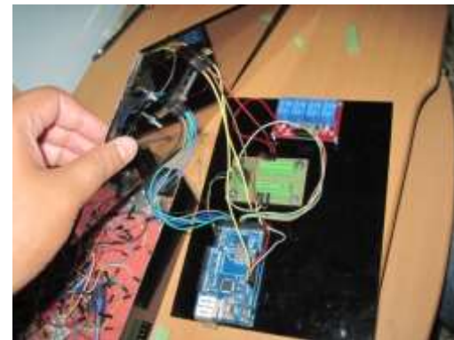
Figura 3.4 Se cableo cada componente uno con otro por medio de cables macho-macho y macho-hembra, se ajustó el VCC/GND de las borneras para su correcta comunicación entre cada componente electrónico.
