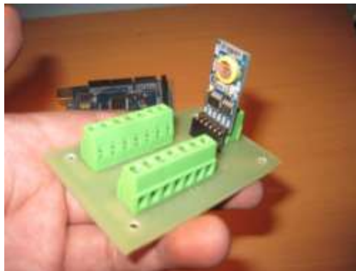
Vista frontal de la tableta de cobre finalizada con las borneras VCC/GND y base de pines hembra con su respectivo módulo DS1307 colocado.
