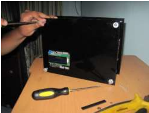
Figura 3.5 Se unieron las piezas del acrílico utilizando tornillos de 5 pulgadas
