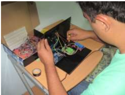
Figura 3.4 Se cableo cada componente uno con otro por medio de cables macho-macho y macho-hembra, se ajustó el VCC/GND de las borneras para su correcta comunicación entre cada componente electrónico.
