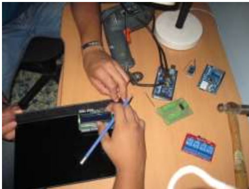
Figura 3.2 Se tomaron las medidas de cada componente para su correcta distribución en el acrílico luego se perforo y se ajusto al mismo mediante tornillos.
