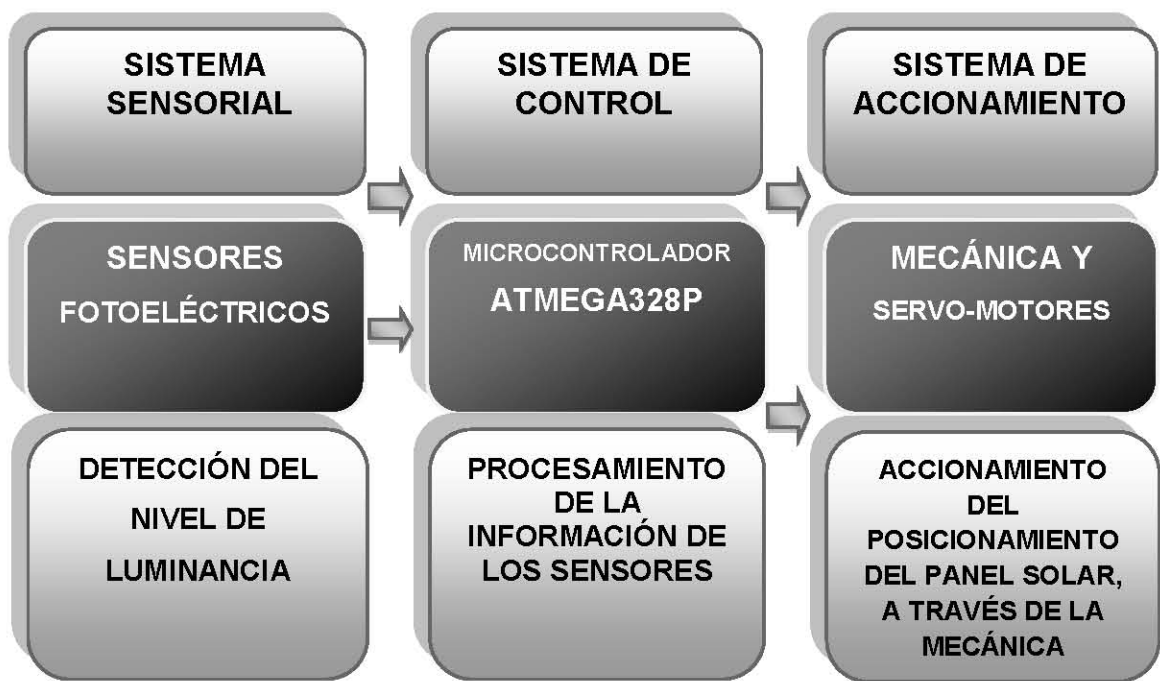
Figura 2.5: Esquema general de las partes principales del prototipo.
