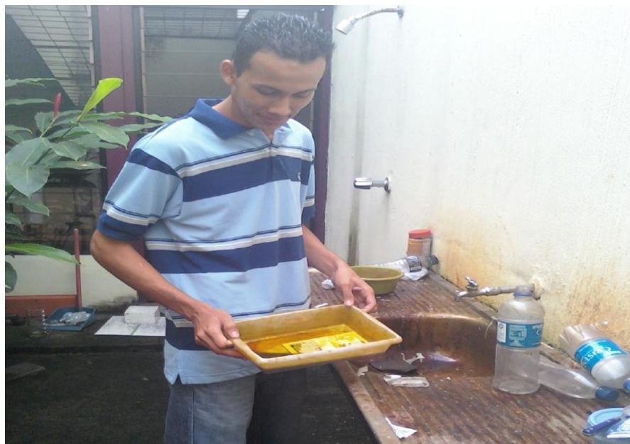
Figura 3.6 Después de imprimir el circuito se pasa al planchado.
