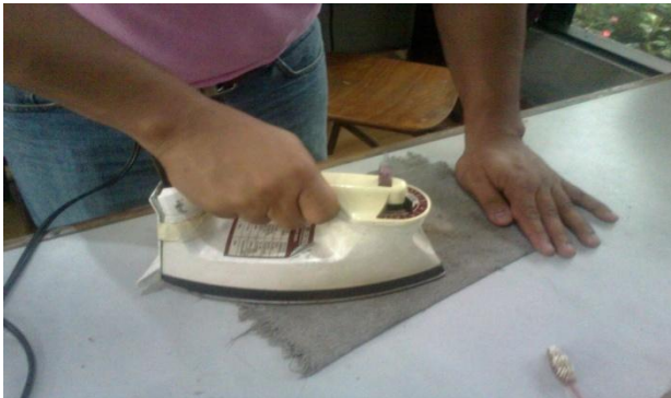
FIGURA 3.5 Transferencia del circuito impreso a la tableta de cobre.
