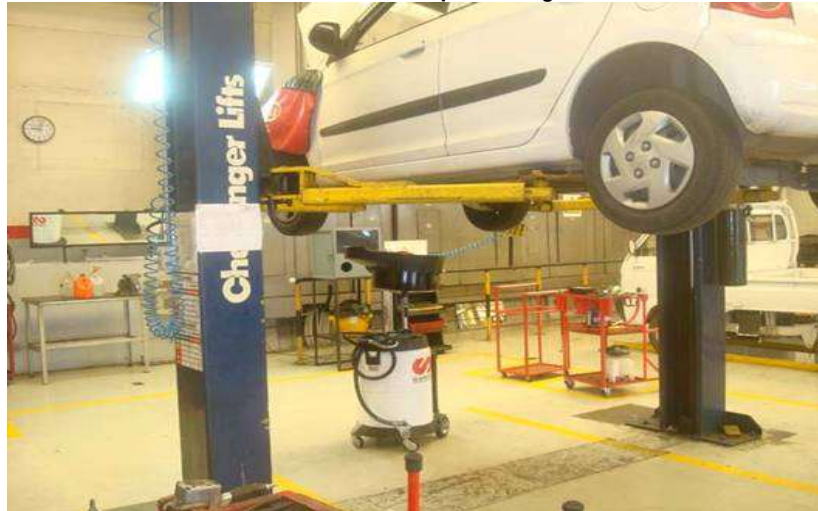
Figura No. 5 Proceso de recolección de líquido refrigerante usado.
