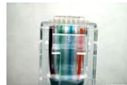
Figura 3.24 Hilos dentro de RJ-45 macho
