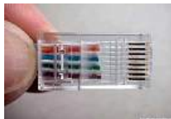
Figura 3.24 Hilos dentro de RJ-45 macho
