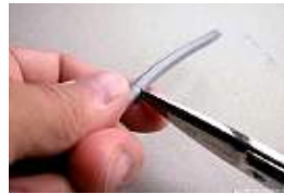
Figura 3.20 Cortar el cable
