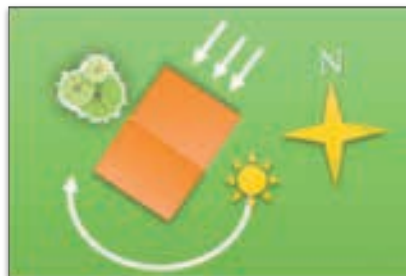
Orientación de la vivienda respecto a los vientos dominantes y radiación solar
