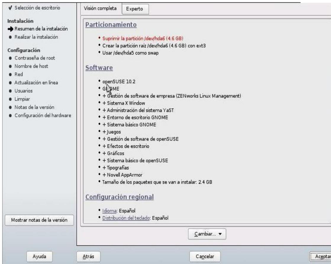
En esta ventana muestra las configuraciones a realizar como las particiones que se crearan, el software que se instalará y la configuración regional. Si se desea cambiar esta configuración, solamente hacer clic en “Cambiar...” y realizar los cambios deseados. Cuando se esté de acuerdo con la configuración, hacer clic en aceptar.
