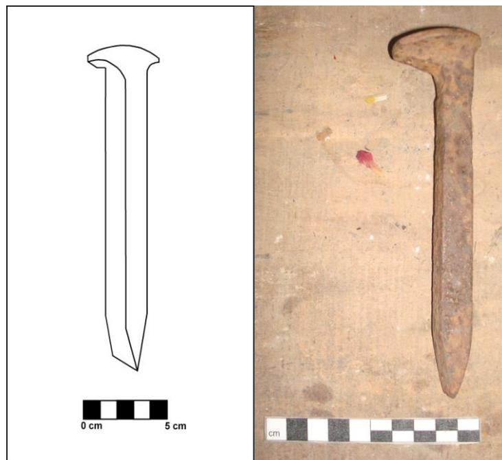
**Figura 25. Clavo metálico, utilizado para sujetar riel y durmiente**
