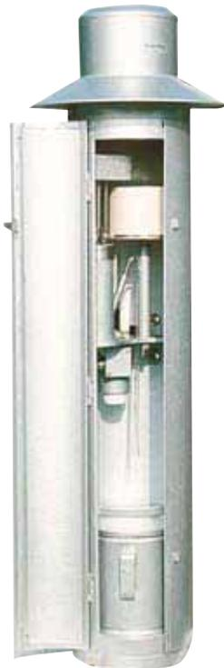
► Pluviómetro de Hellman. El pluviómetro se usaba para medir la cantidad de lluvia caída.
