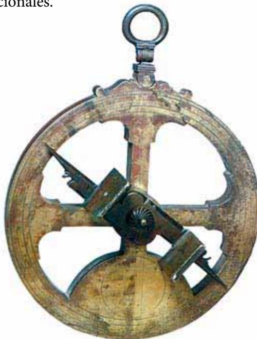
▶ El astrolabio sirve para medir la altura angular (en grados de arco) de los objetos sobre el horizonte.
