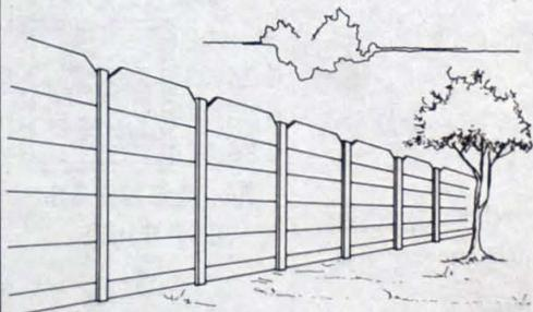
PERSPECTIVA DEL MURO PREFABRICADO
