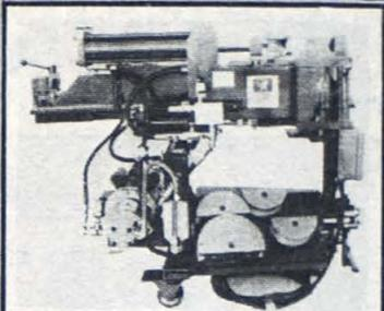
La máquina especializada Blue Boy, ejecuta con precisión los dobleces y curvaturas necesarios para que la cola de escape se ajuste a cabalidad a la disposición del vehículo, asegurando un adecuado funcionamiento.
