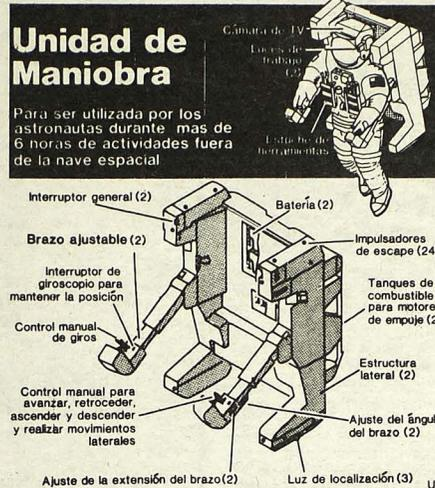
PARA MANIOBRAS. Cabo Cañaveral, febrero 3 (UPI). Dibujo que muestra el funcionamiento del aparato construido especialmente para que la actual tripulación del Challenger efectúe trabajos e investigaciones fuera de la nave espacial. El instrumento permite todo movimiento, así como subir, bajar y girar.
