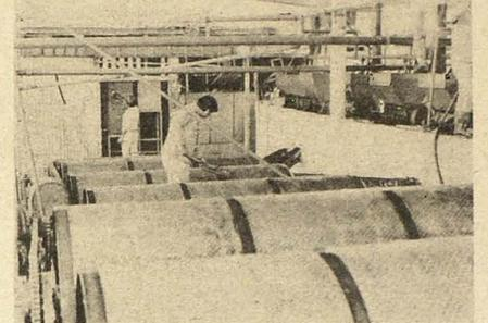
**CRIBAS.** Las planchas metálicas de forma circular, que sirven para separar el café de las impurezas cuando viene, actúan por ventilación natural. Así se observa en los beneficios del INCAFE, cuando se desarrolla la mencionada labor, como parte de la selección del mejor grano.
