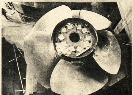
ELECTRIFICACION NACIONAL.— Desde el puente Cuscatlán se ven los trabajos de la central hidroeléctrica de San Lorenzo y los materiales acumulados a la orilla del Lempa para construir la presa. En la foto inferior: álabes de la turbina, listo para su montaje en casa de máquinas. Compárese tamaño con la figura humana. La CEL espera poner en marcha la primera unidad generadora a mediados de 1983. San Lorenzo tendrá una capacidad instalada de 180.000 kilovatios.
