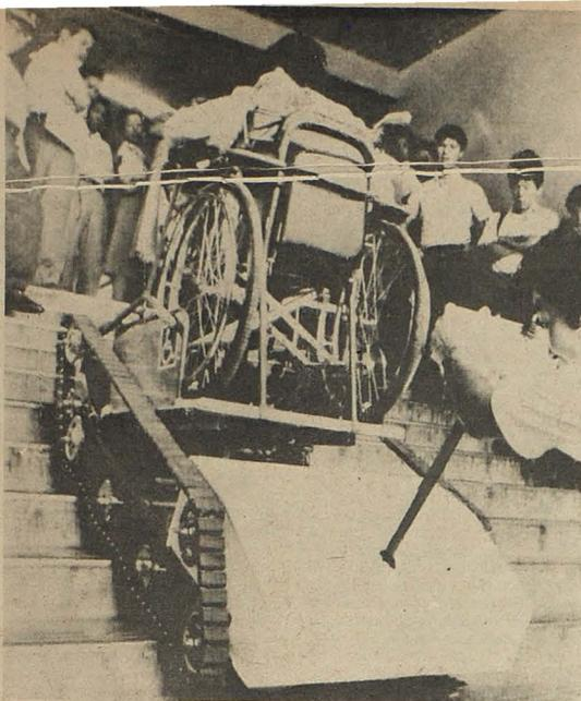
SILLA DE RUEDAS SUBE ESCALERA. Osaka, Japón, agosto 18. Una carreta con bandas transportadoras accionadas por baterías sube las escaleras con una persona en silla de ruedas en la estación del ferrocarril en Osaka.
